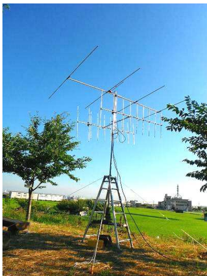
FZG 考案 脚立を利用したルーフ タワーに2mと6mのアンテナ
