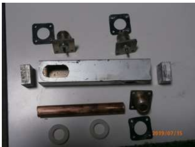
左右、同じ特性の 50Ω ダミー疑似負荷で調整
