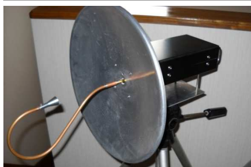
クーラー配管用の銅管を曲げて作った放射器 47GHz、トランスパーターの俗称：「ぞうの鼻」
